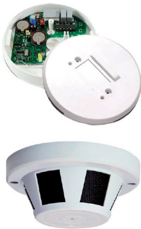
Σχήμα 2.2: Ανιχνευτής καπνού και εσωτερικά κυκλώματα υποστήριξης.
